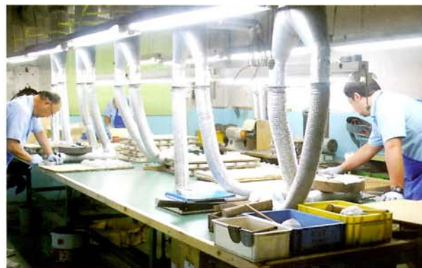
マグネシウムの磨き加工の様子。現在、航空機部品受注を目指し、磨きから機械加工まで一貫生産が可能な体制の確立を目指している
