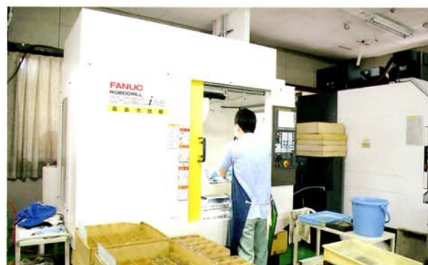
導入したマシニングセンタ。磨きで仕上げた部品に穴開けの加工を施す
